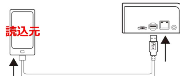
携帯電話が正しく接続されると、[読み込中]LEDが緑点灯となり、読み込みが始まります。(読み込中は真ん中3つのLEDが順番に橙点滅します。)
