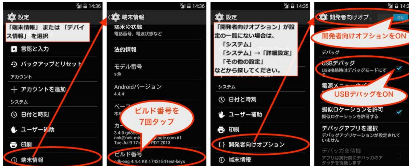
◇ 本機の利用が完了したら、このUSBデバッグの設定をOFFに戻してください。
