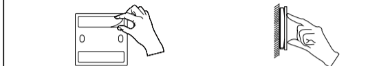
① 両面テープをスイッチ裏面に貼る ② スイッチを平らな面に貼り付ける
